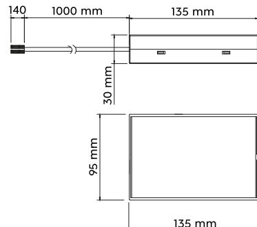
Die flexible Stromversorgung wird benötigt, wenn die Schienen nicht direkt über den Stromauslass verlegt werden können.
