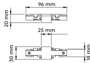
Mittels Isolator können zwei separate Schaltkreise optisch zu einem System verbunden werden.
